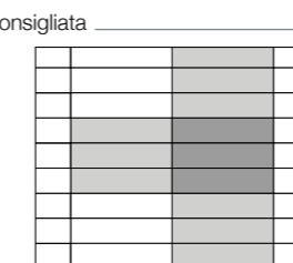
Per la posa ortogonale si consiglia di utilizzare una fuga di 2 mm.
